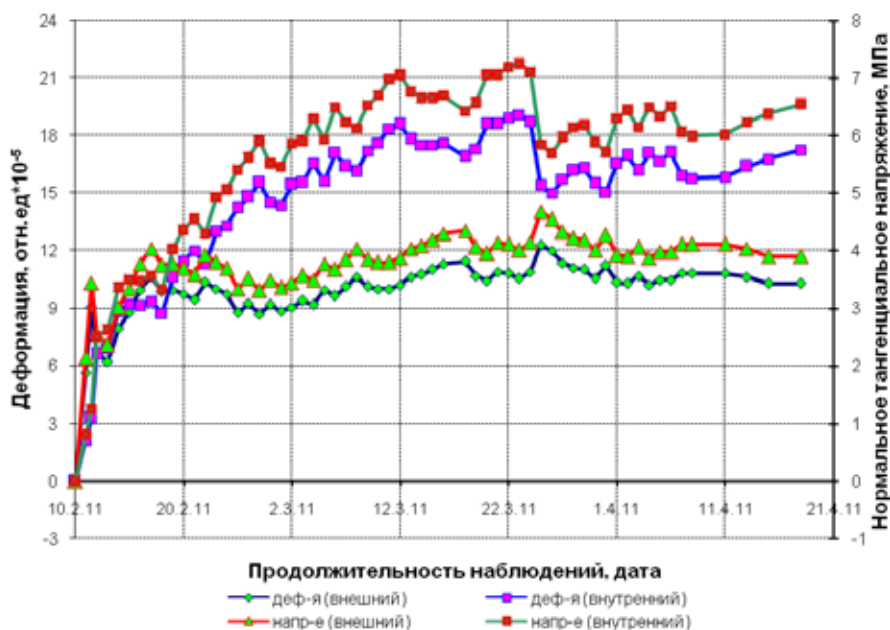
Рис.3. Графики формирования напряженного состояния обделки
